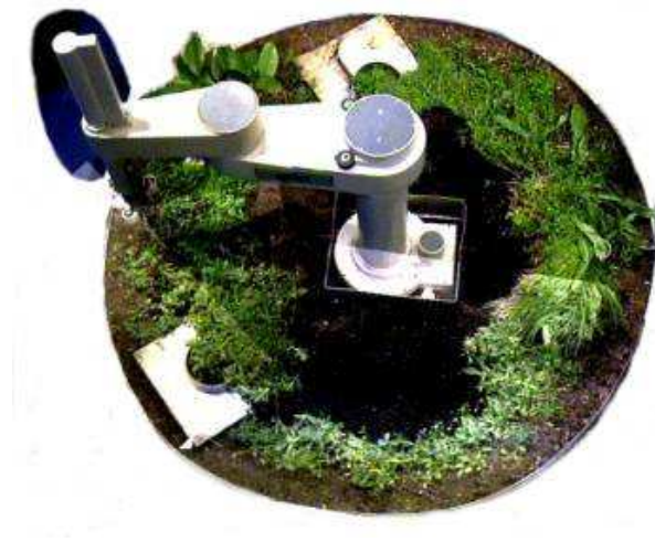
Abbildung 1.3: Der Telegarden Roboter über der runden Pflanzfläche
