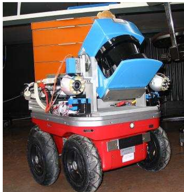
Abbildung 2.2: Der KURT-Rettungsroboter, Outdoor-Version.
