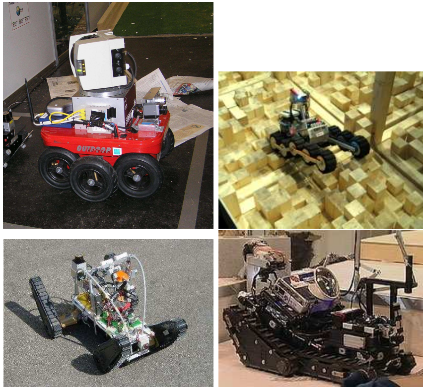
Abbildung 2.5: Oben links: Der Kurt3D des Team Deutschland1, Universität Bonn und Universität Osnabrück, mit einem vertikal drehbar gelagerten Laserscanner der Universität Hannover, der Abstandswerte der gesamten Umgebung liefert. Oben rechts: Einer der Rettungsroboter des Teams Independent aus Thailand, das Team gewann den Gesamtpreis beim RoboCup Rescue 2006. Unten links: Der Lurker-Rettungsroboter der Universität Freiburg, Gewinner in der Autonomiewertung. Unten rechts: Der Roboter des Teams Shinobi aus Japan wurde für die beste Fortbewegungsfähigkeit ausgezeichnet.
