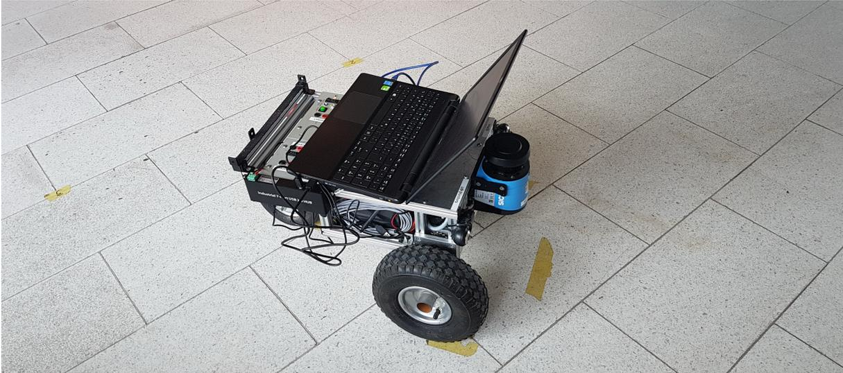
**Abbildung 3.7:** Volksbot-Roboter
