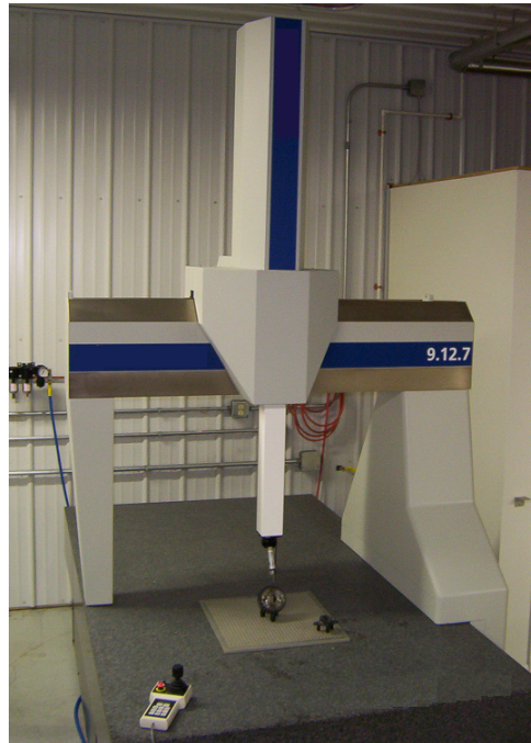
Abbildung 2.4: Ein Koordinatenmessgerät in Portalbauweise [1].
