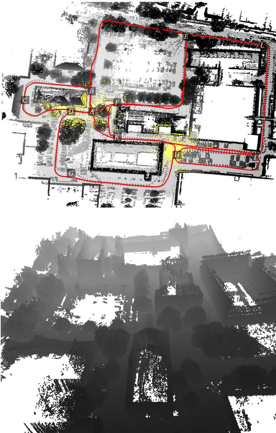
**Abbildung 4.2:** Oben: Draufsicht auf die mit ELCH erstellte Karte aus dem Datensatz HANNOVER 2. Die Scans sind entlang der roten Trajektorie in folgender Reihenfolge aufgenommen worden: *A-B-C-D-A-B-E-F-A-D-G-H-I-J-H-K-F-E-L-I-K-A*. Scans, welche in der Arbeit besonders ausgewertet werden, sind gelb markiert. Unten: Schrägsicht aus Richtung Westen.
