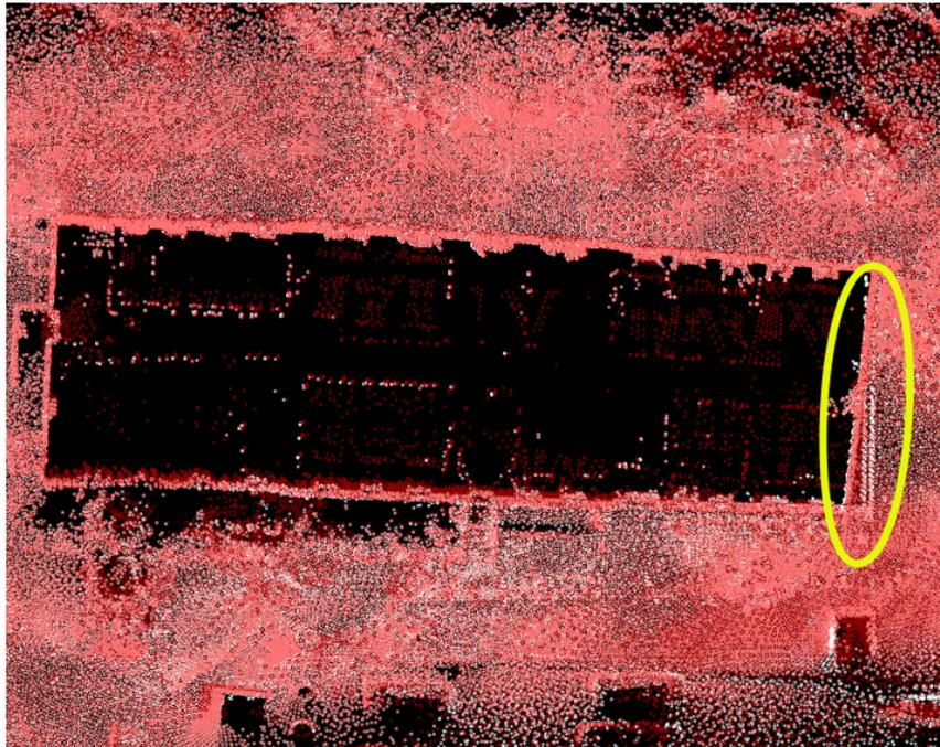
Bild 3.4: Vergleich lokal optimale globale Helixkorrektur (Rot) mit unkorrigierter Karte (Weiß)
