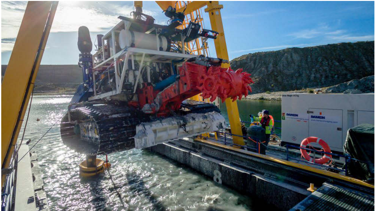
Abbildung 1.1: ¡VAMOS! Unterwasserbergbausystem bei dem ersten Feldtest in Lee Moor, England.
