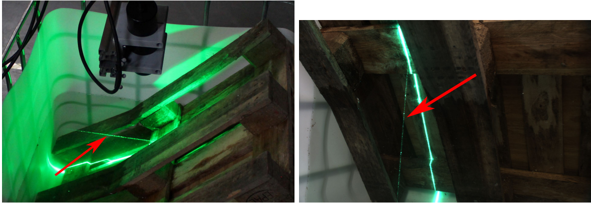
Abbildung 5.1: In diesen Abbildungen ist, an den gekennzeichneten Stellen, die Reflexion der Laserlinie auf der Wasseroberfläche zu erkennen. Diese Reflexion ermöglicht eine Bestimmung der Ebenenparameter aus dem 3D-Scan, ohne dass hierzu ein externes Trackingsystem benötigt wird.
