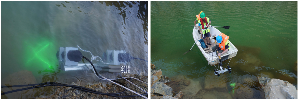
Abbildung 4.6: Auf dem linken Bild ist der SL-Kreuzlinienlaserscanner bei den ersten Feldtest in einem See eines Steinbruchs zu sehen. Neben dem projizierten Laserkreuz ist die Lichtstreuung durch Schwebeteilchen im Wasser sehr gut zu erkennen. Das rechte Bild zeigt, wie die ersten Aufnahmen auf einem See, aus einem Boot heraus entstanden sind. Die gefahrene Trajektorie wurde hierbei durch die am SL-Kreuzlinienlaserscanner befestigte GPS-Antenne aufgezeichnet.
