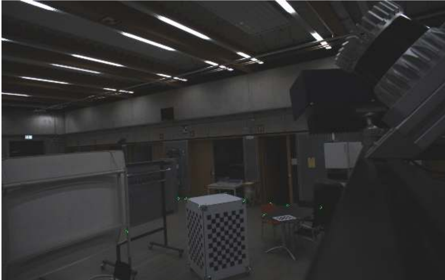
Abbildung A.9: projizierte 3D-Koordinaten ins Kamerakoordinatensystem – Position mittig, Punktwolken Aggregation “union”
