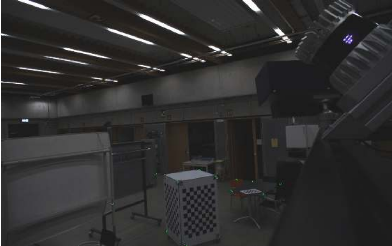
Abbildung A.7: projizierte 3D-Koordinaten ins Kamerakoordinatensystem – Position “mittig”, Punktwolken Aggregation “average”
