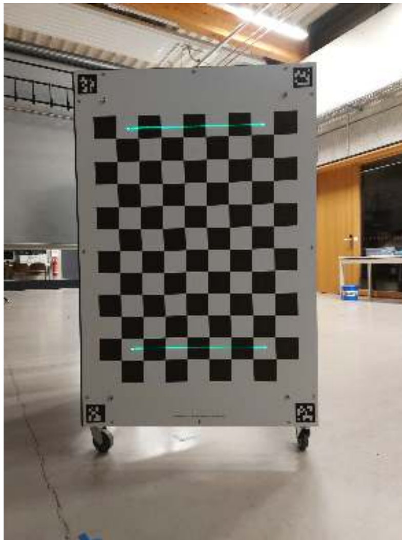
Abbildung 4.2: Projektor projiziert Linie auf verschobene Schachecken
