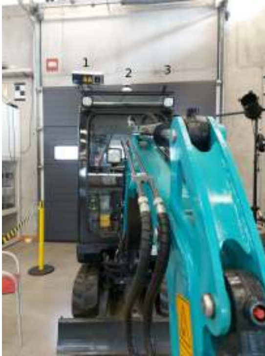
(a) Bagger mit Projektor (1), Laserscanner (2) und Kamera (3)
