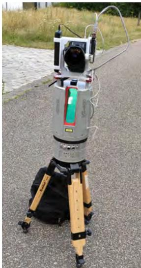
**Abbildung 2.1:** Riegl VZ-400 3D-Laserscanner mit aufgesetzter Kamera.
