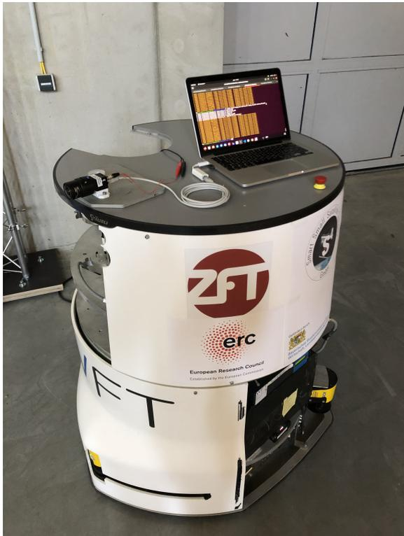
(a) Stäubli WFT HelMo Roboter mit fixierter Kamera (FLIR Blackfly S) und Rechner.
