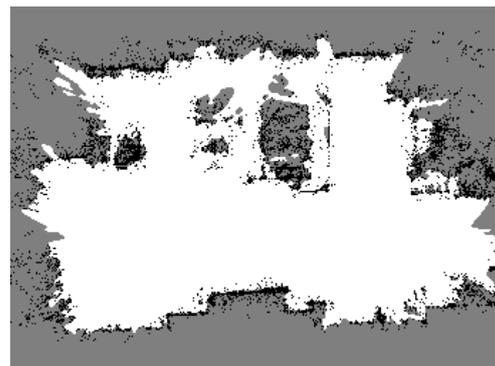
(e) **Schritt 4:** Erneutes Filtern *belegter* Zellen. (f) **Schritt 5:** Glättung nicht-*belegter* Zellen.
