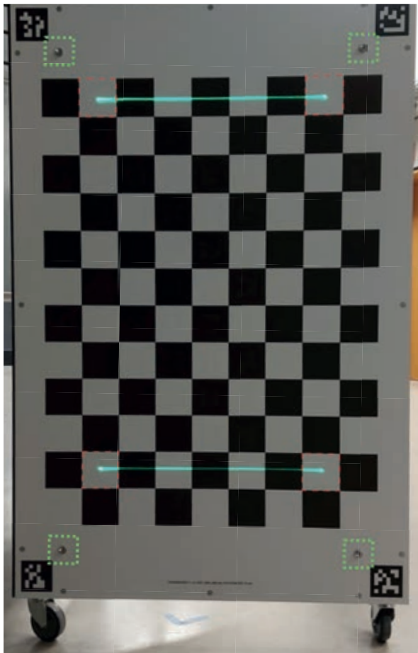
Abb. 6 | Der Projektor projiziert zwei Linien für die Auswertung der Kalibrierung. Die Enden der grünen Linie soll im Zentrum der rot umstrichelten Felder liegen. Die Reflektoren befinden sich im Zentrum der grün gepunkteten Umrandung.
