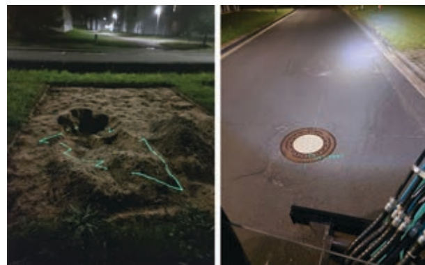
Abb. 7 | An die Umgebung angepasste Projektion eines Tannenbaums (links) und eines Abwasserrohrs inkl. Beschriftung (rechts). Wenn eine Linie nicht projiziert werden kann, da z.B. ein Objekt im Weg ist, so wird der Teil der Projektion ausgelassen.
