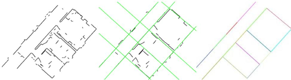
**Abb. 7:** Die Vektorisierung der Scanpunkte von links nach rechts: Liniensegmentierung, Bestimmung dominanter Geraden, erneute Liniensegmentierung. Zur Verbesserung der Sichtbarkeit wurden die Linien mit einer erhöhten Stärke gezeichnet.
