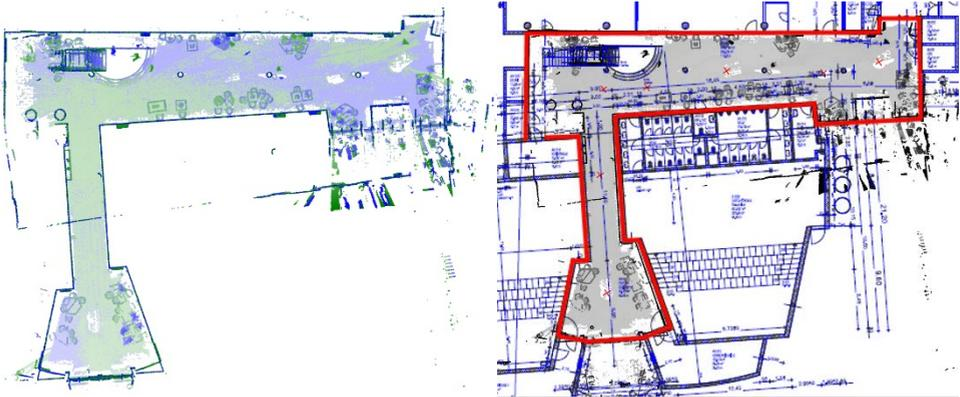
**Abb. 5:** Links: Die registrierten 3D-Scans aus Teach-In (blau) und Pfadverfolgung als Draufsicht (grün), eingefärbt über einen Höhenfarbverlauf und ab einer Höhe kurz unter der Decke abgeschnitten. Rechts: Die Scanpositionen in der registrierten finalen 3D-Punktwolke überlagert mit dem offiziellen Grundriss.
