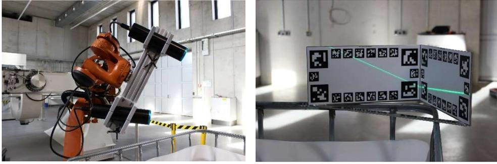
**Abb. 4:** Kalibrierung der Laserebene unter Verwendung einer L-förmigen 3D-Struktur.
