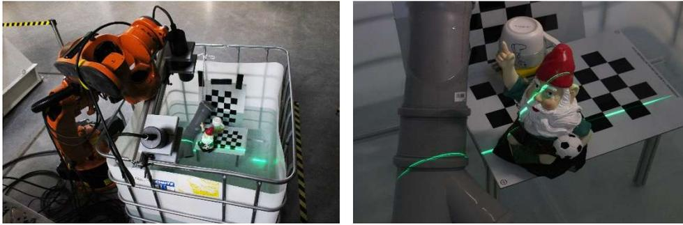
**Abb. 7:** Links: Aufzeichnung einer halb im Wasser versunkenen Szene mit dem an einem Manipulator befestigten Scanner. Rechts: Detailansicht der aufgezeichneten Szene mit der Laserlinie des Scanners im Bild.
