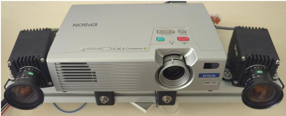
**Abb. 3:** Experimentelles Stereokamerasystem mit Projektor.
