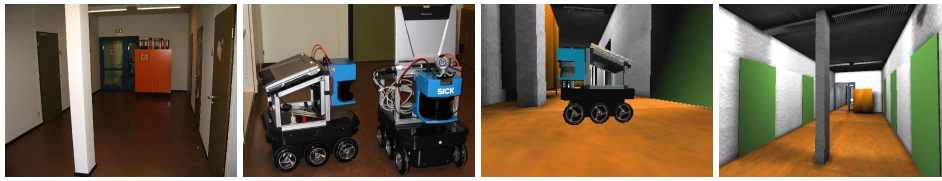
Abbildung 2: Links: AVZ-Gebäude Osnabrück und KURT2 real. Rechts: Gebäude und KURT2 simuliert. Mehr Material unter http://kos.informatik.uos.de/download/UOSSim/index.html
