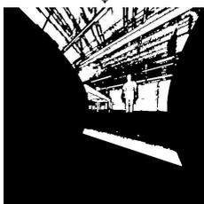
Die Objekte im binarisierten Bild werden durch die morphologische Öffnungsoperation besser voneinander separiert. Kleine Strukturen werden komplett unterdrückt.
